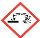
Dos probetas vertiendo una sustancia significa que se trata de un producto corrosivo tanto sobre otros objetos y superficies metálicas como en humanos. En este caso puede provocar quemaduras cutáneas y lesiones oculares de carácter grave.
